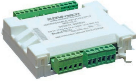
M 9000A IO 1/1 M 9000A IO 3/5 ADRESLİ Giriş/Çıkış Modülü 1/3 Giriş ve 1/5 Çıkış DMTech haberleşme protokolü
