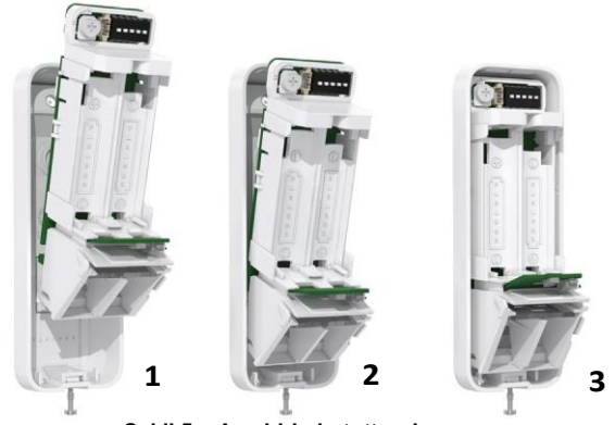
Şekil 5 – Ana birimin tutturulması
