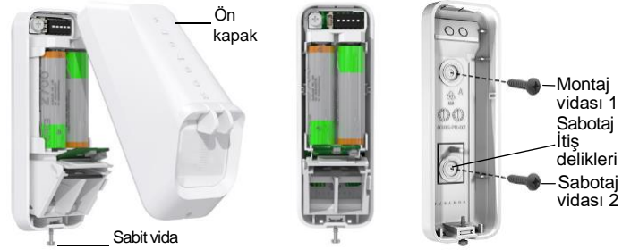
Şekil 1 – Ön kapağın çıkarılması
