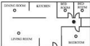
Şekil 1: TEK BİR UYUMA ALANINA SAHİP BİR KONUTTA DUMAN DEDEKTÖRLERİNİN BULUNMASI GEREKEN KONUMLAR
