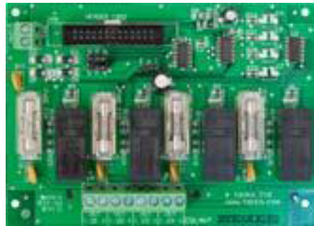
Şekil 19. MER-4 röle genişletme kartı
