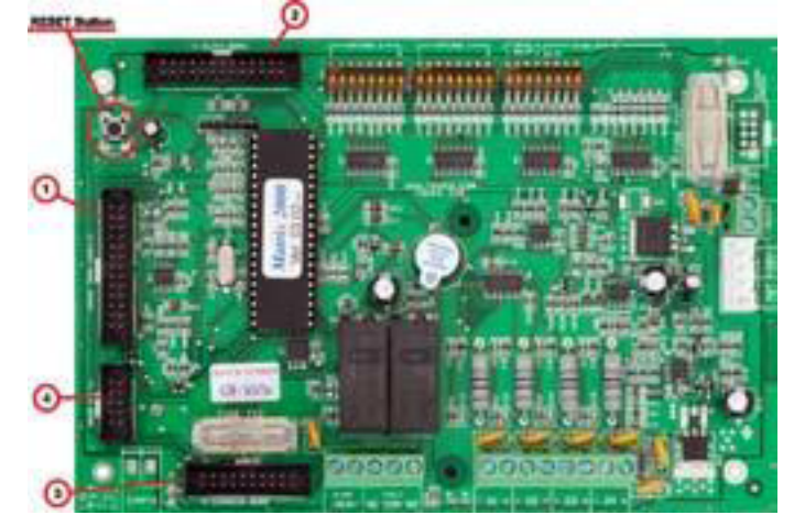
Şekil 16. Matrix2000 ana kartı yanbirim bağlantıları
