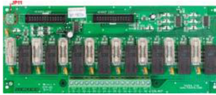
Şekil 20. MER-8 röle genişletme kartı
